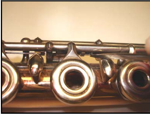
Figure 4.61: Unhooking the E Key Spring
